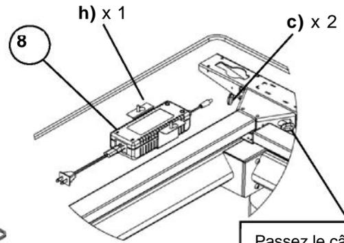
Passez le câble du panneau de contrôle avec le connecteur rouge par ces perforations et connectez le à l'alimentation
