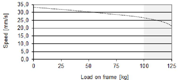
La courbe ci-dessus s'applique pour une charge placée au centre et n'est valable que dans le respect du cycle d'utilisation : 10 % par 50 % de charge de travail maximale ou max. 2 min. en continu. Les spécifications ci-dessus peuvent varier en fonction de la température locale, de l'humidité et la tension d'entrée.
